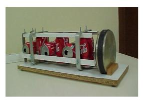
El modelo utilizado fue un conjunto de latas de Coca-cola colocadas en hilera intercaladas de forma horizontal y vertical. A través de múltiples medidas llegué a obtener su propia frecuencia, 132 hercios. A partir del conocimiento de su naturaleza que es esta frecuencia fui demostrando como le afectan otras frecuencias externas
